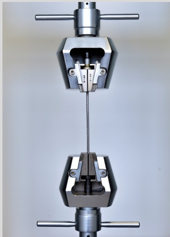
Keilspannzeug mit Gewindeprobe Wedge grips with threaded rod
