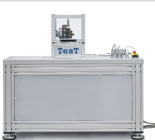
Vibrationsprüfung nach „Junker“ Vibration testing acc. to „Junker“
